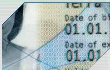
10. lasersko graviranje podob in besedila
